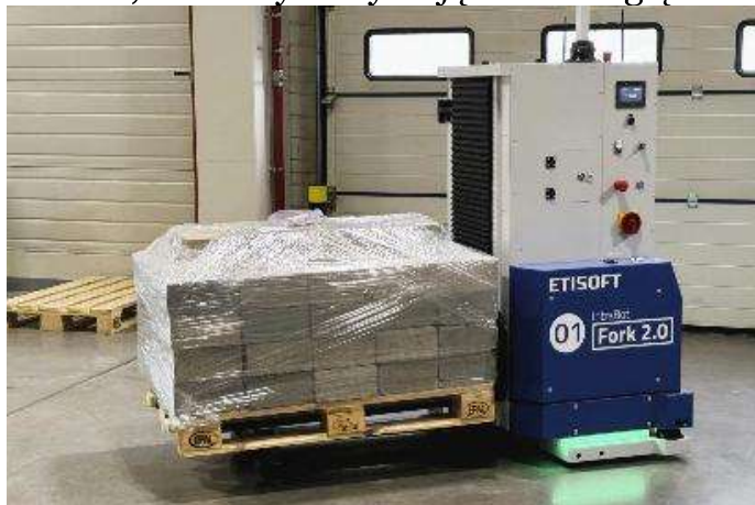
Rys. 6. Autonomiczny wózek widłowy IntraBot Fork firmy Edisoft
