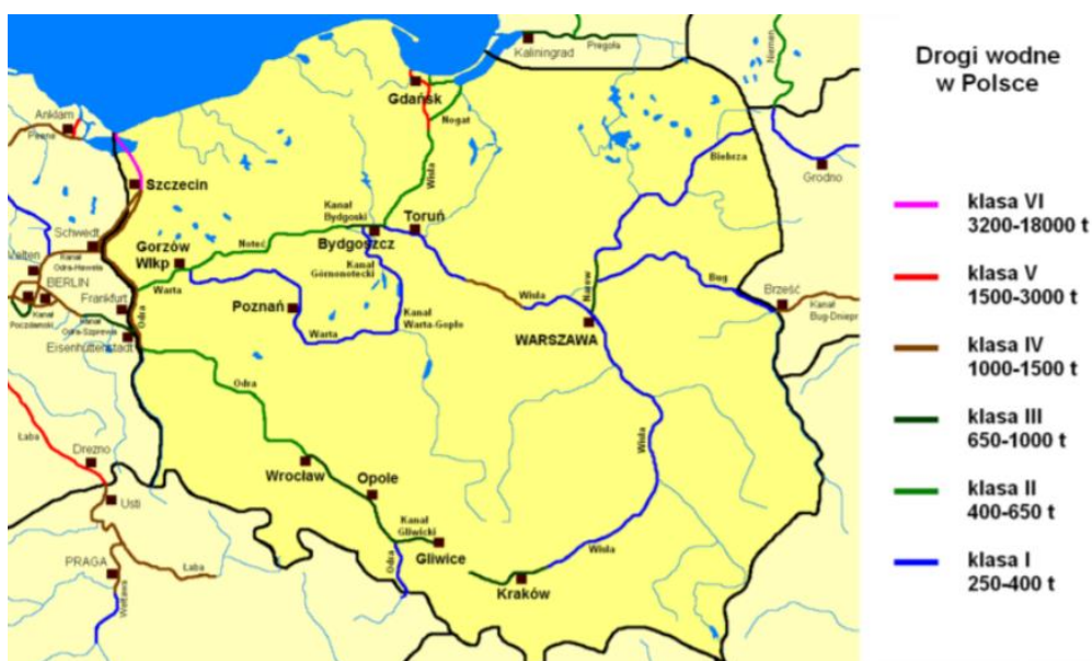
Rys. 13.6. Schemat śródlądowych dróg wodnych w Polsce z podziałem na klasy żeglowności
