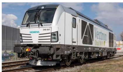
Rys. 1.15. Lokomotywa hybrydowa Siemens Vectron Dual Mode
