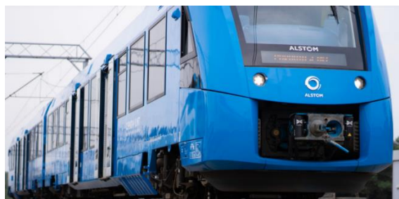
Rys. 2.4. Pociąg iLint z Alstomu na paliwo wodorowe
