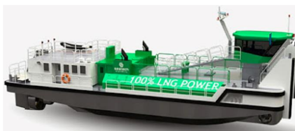
Rys. 14.11. Projekt pchacza rzecznoego zasilanego LNG
