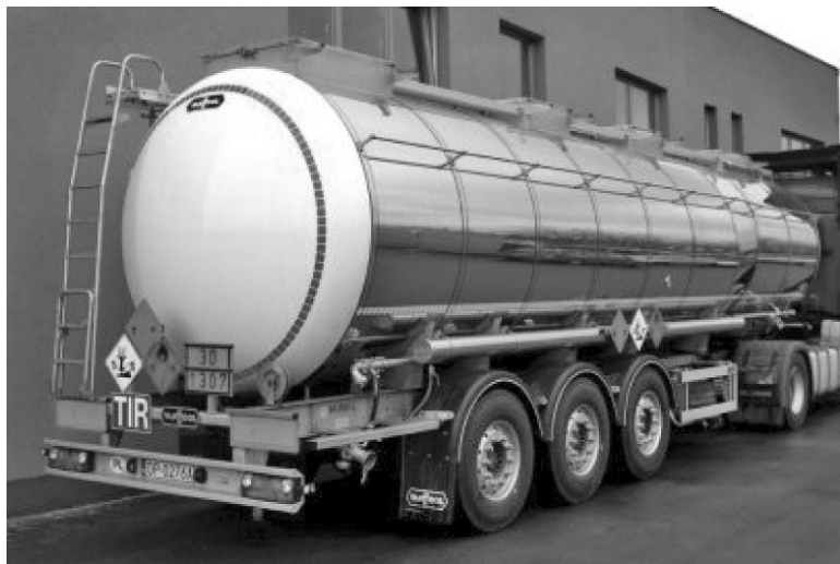
Ryc. 12.2. Cysterna do przewozu płynnych materiałów niebezpiecznych
