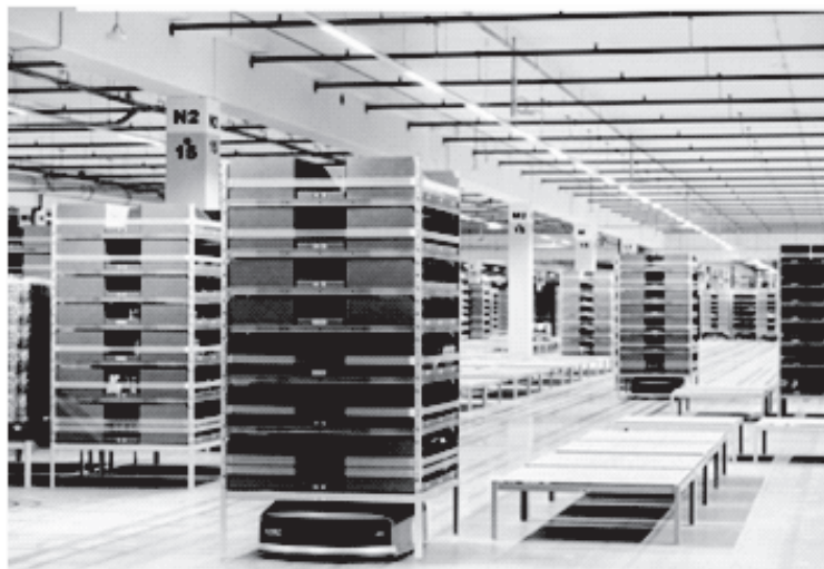
Ryc. 10.1. Zrobotyzowany magazyn z systemem Amazon Robotics
