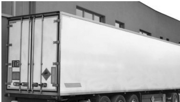
Ryc. 12.3. IZO-kontener do przewozu stałych materiałów niebezpiecznych
